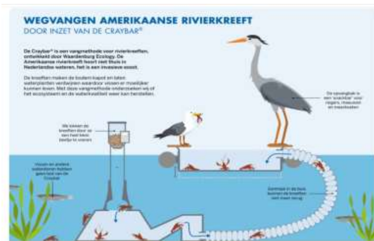
Figuur 4. Werking van de kreeftensleuf. Bron: waterschap zuiderzeeland.nl
