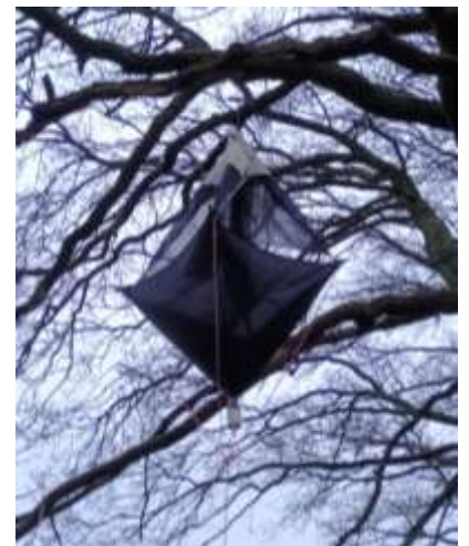
Figuur 12. De malaise-val bleek kwetsbaar. Herhaalde malen brak het aluminium frame bij sterke wind (foto Paul van Wielink).
