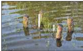
foto 4a/b: beide grondwaterstandsbuizen in De Dongevallei bij laag- en bij hoogwater.
