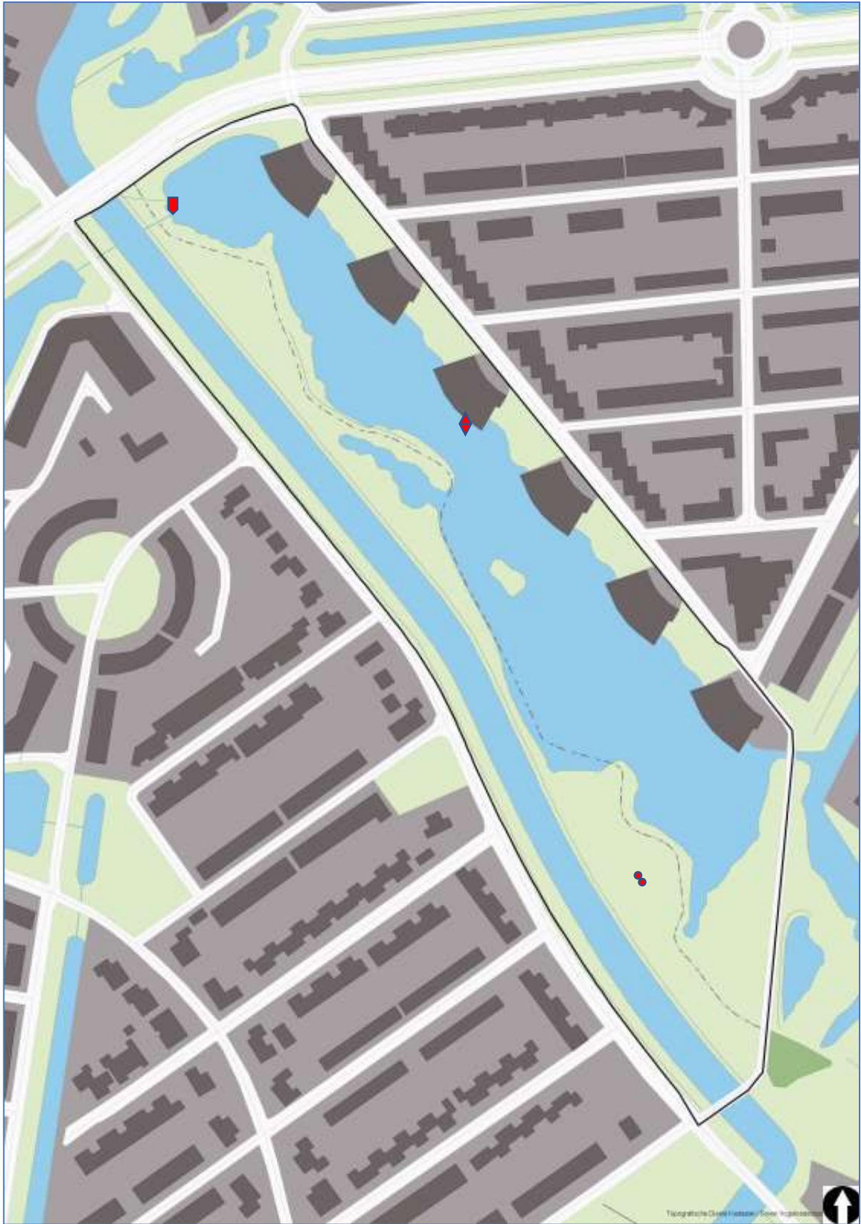
MARLEPLAS (Dongevallei, Tilburg) ◆ peilschaal ●● grondwaterstandsbuizen ◆ NAP-hoogte +6,20m
