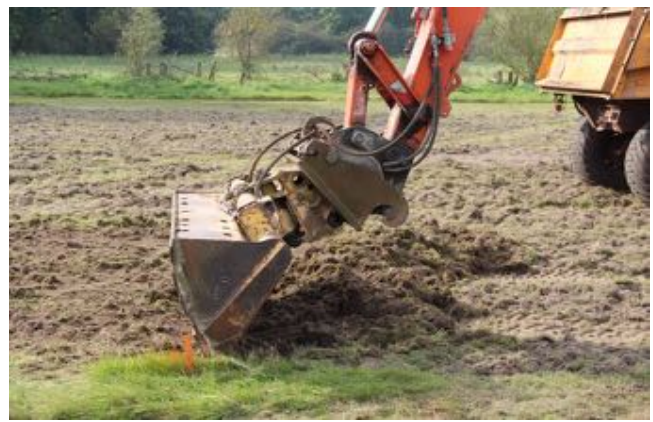
Figuur 9. Detailfoto chopperen; deel van de niet gefreesde wortelzone blijft dus achter.
